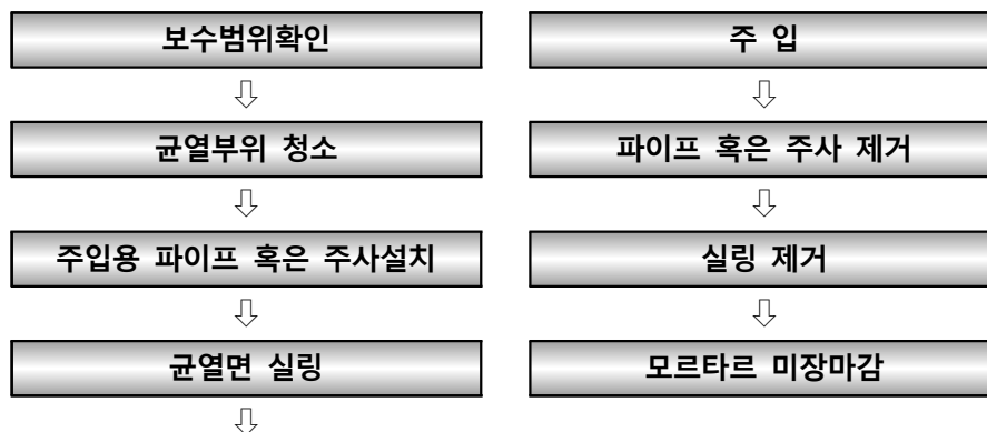
[그림 7.3.3] 주입공법의 시공순서
